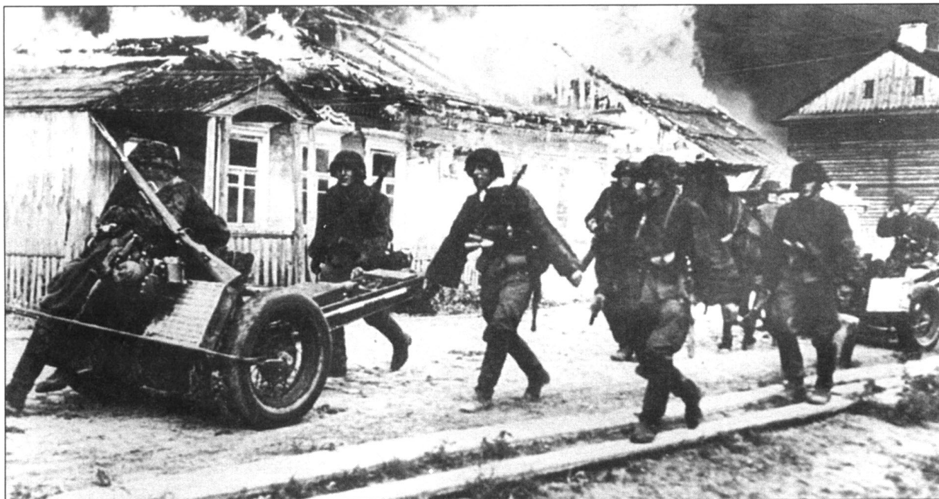
Группа эссовцев в горящей русской деревне. На конной тяге - легкие гаубицы 7,5 см leFH-18. Необычно крепление гаубиц. Упряжь закреплена за оси колес, а гаубицы развернуты станинами назад. Станины на весу поддерживают солдаты. На щитах гаубиц закреплено по ящику со снарядами. Ящики, в данном случае, выполняют роль балансиров, частично компенсируя массу станин.
