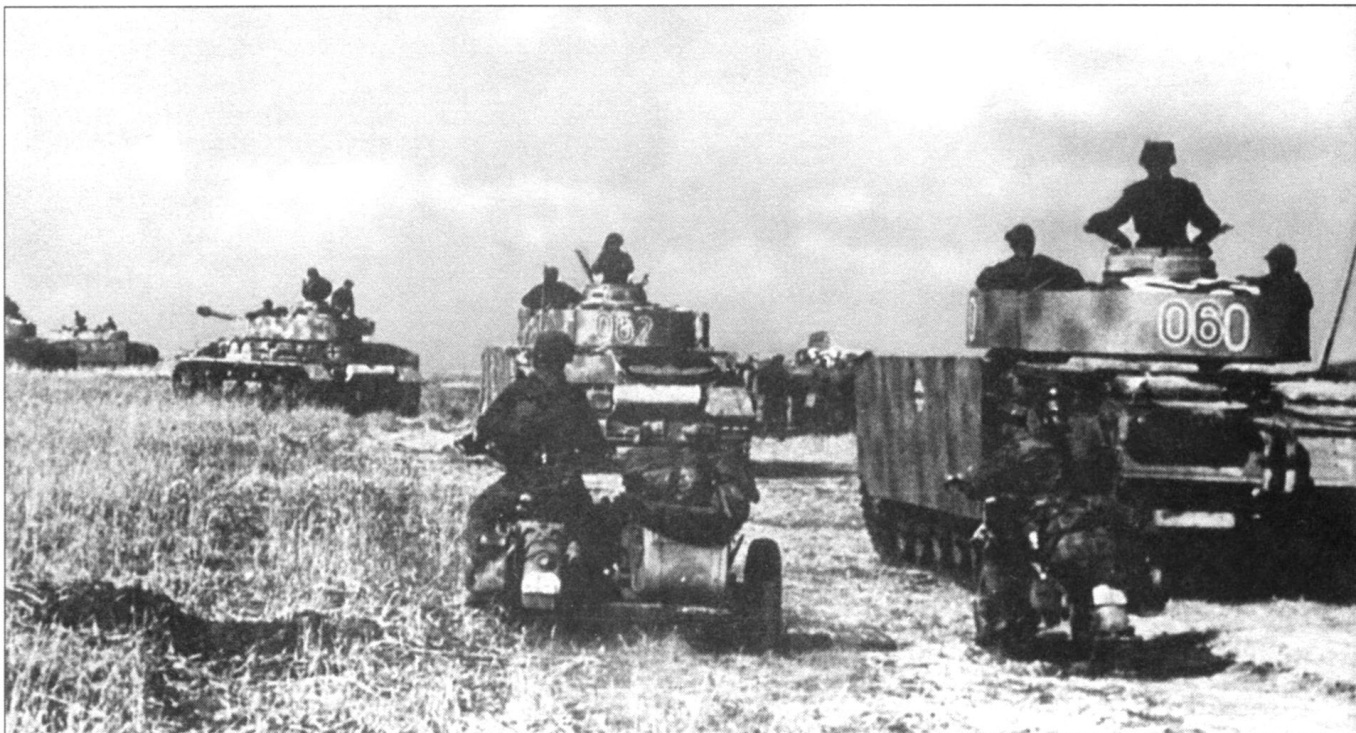
Колонна танков дивизии СС движется к передовой. На переднем плане - танк Pz.Krpfw. III Ausf. M, полностью укомплектованный бортовыми экранами. Камуфляж - пятна зеленого цвета по темно-желтому фону. Tактический номер «060», первые две цифры - красные с белой обводкой, последний «0» - белый с очень тонкой черной окантовкой. Впереди - более мощный Pz.Krpfw. IV Ausf. H, вооруженный 75-мм пушкой с длиной ствола 48 калибра.
