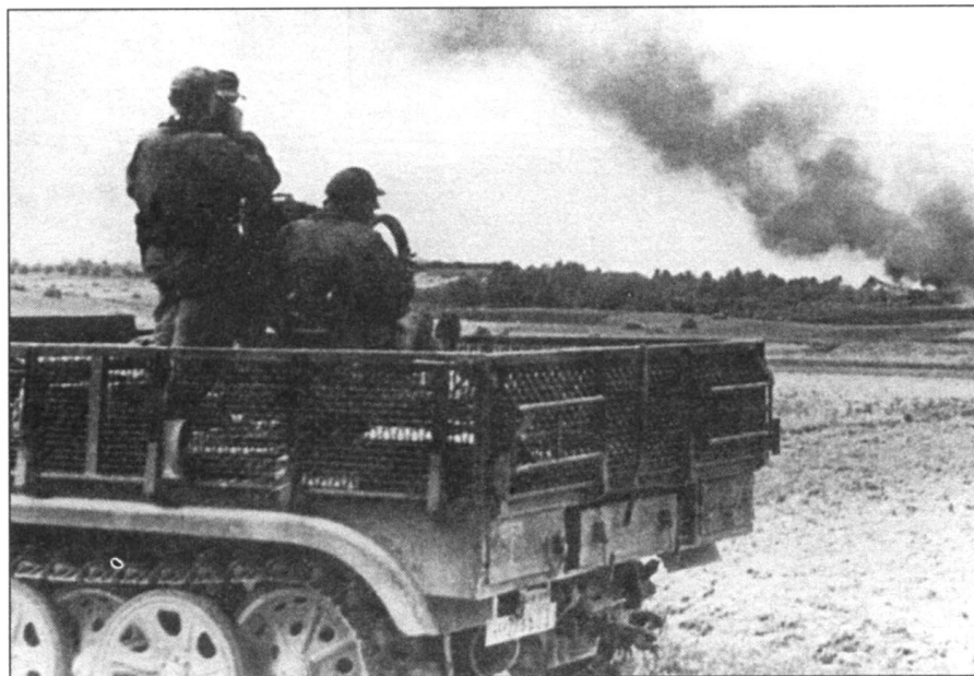
Полугусеничный транспортер Sd.Kfz. 7, доработанный под установку зенитки 2cm FlaK-38. Весьма необычная машина. На тяжелые транспортеры Sd.Kfz. 7 обычно ставили более серьезное зенитное вооружение: 2 cm Flakvierling-38 или 3,7cm FlaK-36. Регистрационный номер машины - «SS-273603». На заднем борту кузова изображен тактический знак батареи буксируемых зениток. Снимок сделан в октябре 1943 г. на севере Украины.
