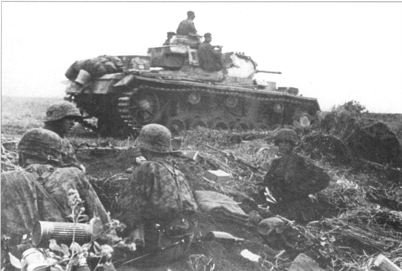
Танк Pz.Krfw. III Ausf. J, вооруженный 50-мм пушкой с длиной ствола 42 калибра, район Белгорода, конец августа - начало сентября 1943 г. На обочине стоит сильно замаскированная противотанковая пушка PaK40 калибра 75 мм. Солдат слева одет в камуфлированную куртку раннего типа.
