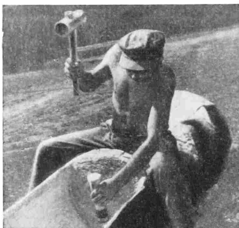
Рис. 5. Постройка лодки. Выравнивание стенок перемычки нефритовым долотом
