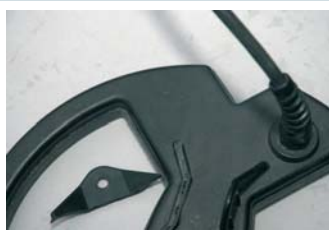
Voilà ce qui peut arriver quand les pattes des disques ne sont pas assez larges...avec les disques SEF : aucun risque !
