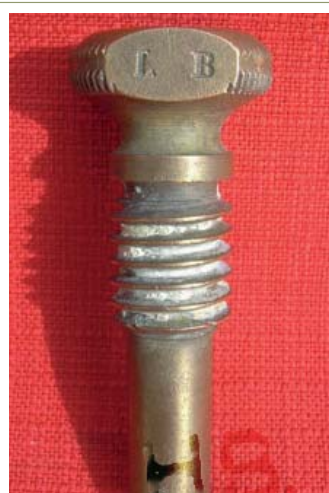
Etoupille à friction pour mortier allemand de taille moyenne qui fut utilisée également en tant qu'allumeur de piégeage sur grenade de type Kugelhandgranat.
