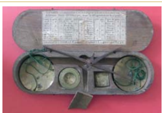
Le trébuchet est un type particulier de balance ordinaire. C'est une balance de précision, utilisée pour peser de faibles quantités de substances. Il était également utilisé pour peser les pièces de monnaies. Collection Com' L'atrebate.
