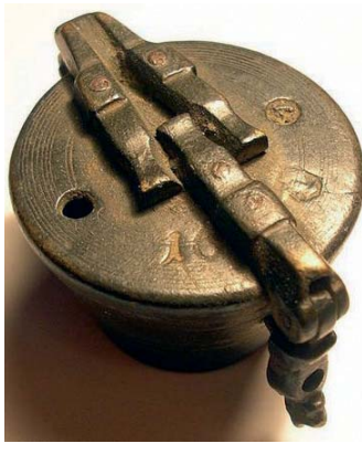
Autre élément de pile à godets, ici le plateau du couvercle (diamètre 40mm). Collection Franckomas34. Les contremarques sont des poinçons de contrôle de balancier un pour la ville (écu au tourteau) pour la ville de Montpellier, un pour le contrôleur du roi (fleur de lys). Objet identifié par Wisigoth du forum du Fouilleur. Ci dessous la boîte renfermant la pile de godets. (diamètre 45mm).
