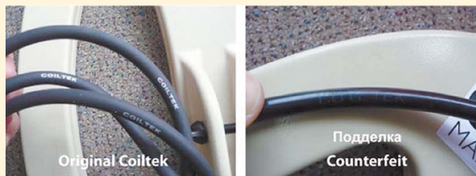
Слева оригинал, справа подделка. Различие кабелей очевидно: кабель оригинальной катушки матовый, и на нем через каждые 170 мм написано Coiltek. Кабель подделки глянцевый, надписей Coiltek на нем нет.
