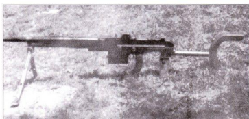
Французский пулемет Mitrailleuse de 7,5 mm mle 1931 (Reibel) . На вооружении немецкой армии этот пулемет известен как 7,5 mm Karpfswagen-MG 311(f) . Это французский танковый пулемет, оснащаемый 150-зарядным барабанным магазином. Немцы добавили к пулемету приклад и сошки, превратив его в пехотный пулемет. Снимок сделан военно-технической службой США.
