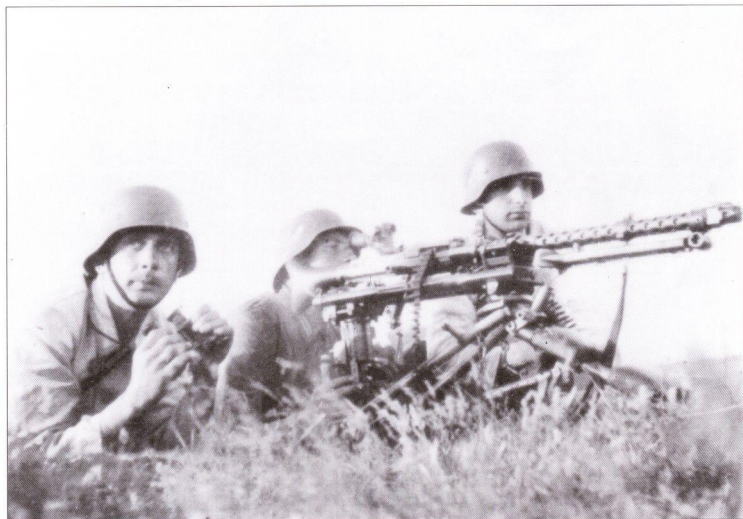
Пулемет MG 34, судя по кожуху ствола из ранней производственной серии. Пулемет установлен на станке с оптическим прицелом.
