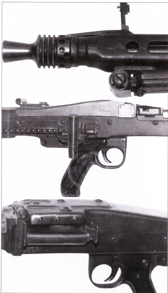
Пулемет MG 42 раннего выпуска, сошки (Zweibein) сняты. Обратите внимание на характерную форму рукоятки затвора.
