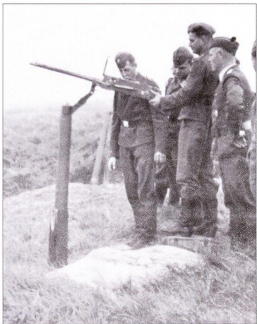
Солдаты люфтваффе изучают чешский MG 30(t) на импровизированном станке. Пулемет питался от 250- или 500-зарядных лент, теоретическая скорострельность 900 выстрелов в минуту.
