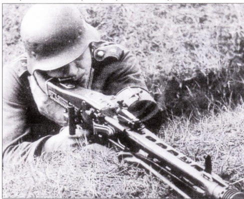
Стрелок демонстрирует различные способы стрельбы из MG 42. Пулемет оснащен 50-зарядным барабанным магазином. Это пулемет позднего выпуска с усовершенствованной рукояткой взвода.
