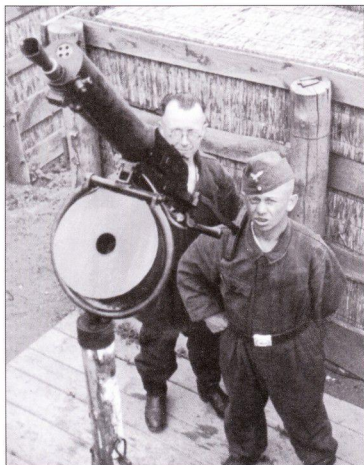
Зенитчик люфтваффе позирует со станковым пулеметом MG 07/12(o). Обратите внимание на кольцевидное крепление к станине и приклад.
