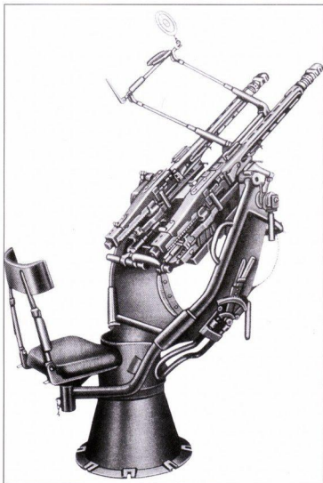
Тумба спаренной установки (Zwillingssockel 36). Приклады с пулеметов сняты. Скорострельность установки 50 или 2400 выстр./мин.
