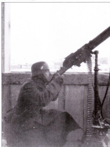
8 мм MG 07/12(o) — австро-венгерский станковый пулемет Schwarzloze . Пулемет приспособлен для стрельбы по воздушным целям.
