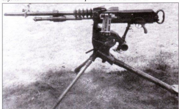
8-мм MG 257(f) — трофейный французский Hotchkiss mle 1914. Снимок сделан американской военно-технической службой после высадки в Нормандии, лето 1944 г.
