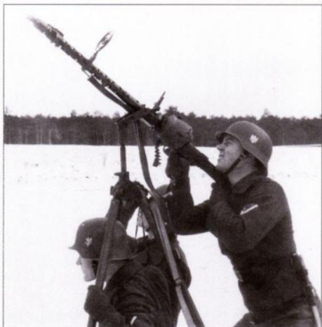
*Второй номер пулеметного расчета удерживает станок, повышая устойчивость последнего при интенсивной стрельбе. Пулемет снаряжен 50-зарядным барабанным магазином.*
