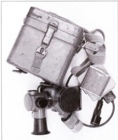
*Оптический прицел MG-Zielfernrohr 34 хранился в металлическом чехле бежевого или темного цвета. К прицелу полагались три батареи Flachbatterie BD 45 DIN VDE 1210, которые запитывали подсветку прицела. Дополнительные светофильтры, салфетки и щеточки входили в комплектацию прицела. Обычно прицел и принадлежности к нему носил командир пулеметного расчета.*
