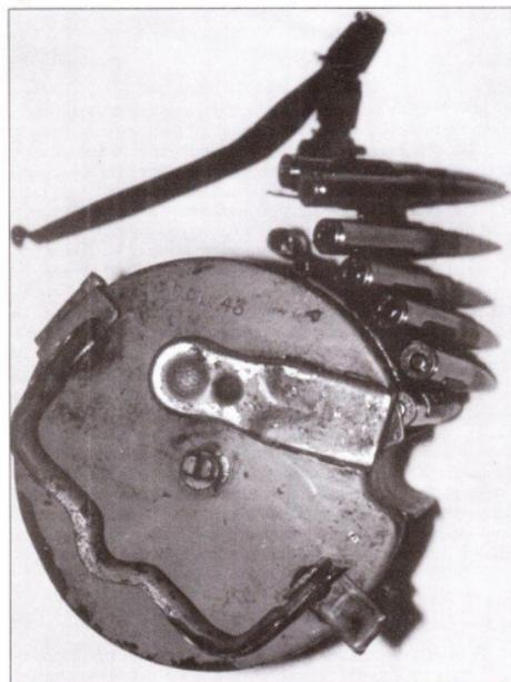
*Два фото: барабанный магазин Gurtrommel 34, внутри которого помещалась 50-зарядная лента.*
