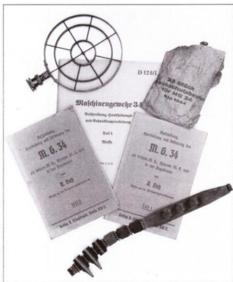
Служебная инструкция (Dienstvorschrift) D 124/1 по эксплуатации ручного, станкового и зенитного пулемета MG 34 в двух частях. Слева вверху кольцевой зенитный прицел. На снимке также виден бумажный пылезащитный мешок (Staubschutzbekleidungsbeutel fuer MG 34) и зарядное приспособление (Einfuehrschueck), позволяющее подавать в пулемет новую ленту, не открывая крышки затвора.
