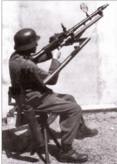
Эссовский пулеметчик демонстрирует возможности зенитного станка MG Socket 41.
