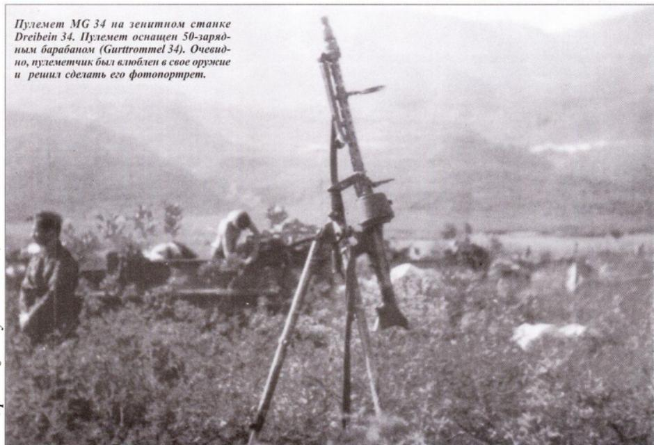
*Пулемет MG 34 на зенитном станке Dreibein 34. Пулемет оснащен 50-зарядным барабаном (Gurttrommel 34). Очевидно, пулеметчик был влюблен в свое оружие и решил сделать его фотопортрет.*
