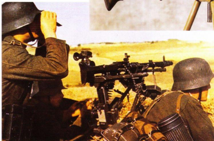
Один из цветных фотоплакатов, распространявшихся в Германии в годы войны. Изображен пулемет MG 34 на станке Lafette 34. Под затвором виден механизм горизонтальной и вертикальной наводки, который позволял вести прицельный огонь по точечным целям. Спуск осуществляется гашеткой, расположенной справа.
