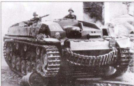
*Штурмовое орудие Sturmgeschuetz III ранней серии, восточный фронт. Эти машины стандартно комплектовались пулеметом MG 34, установленным на крыше у люка заряжающего.*
