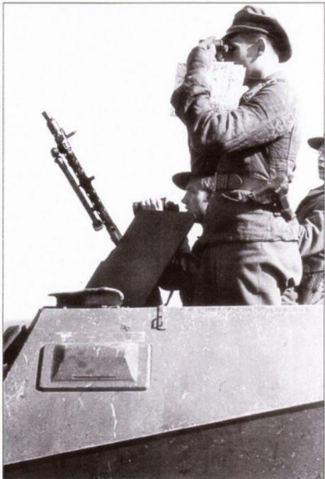
*Передний пулемет полуусеничного бронетранспортера прикрывал легкий бронещиток.*
