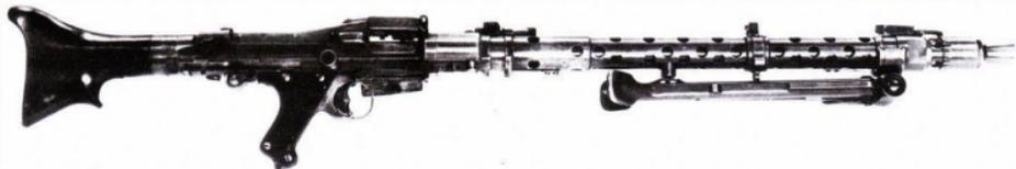
Пулемет MG 34 был создан на фирме Rheinmetall AG, но в его конструкции явно прослеживается влияние со стороны MG 13 и разработок Маузера. Первый единый пулемет (Einheitsmaschinengewehr) был сложным и дорогим в производстве устройством, требующим огромных трудозатрат. Как показал боевой опыт, пулемет не прощал малейшее загрознение, что в конечном итоге привело к необходимости создания принципиально иного пулемета MG 42.
