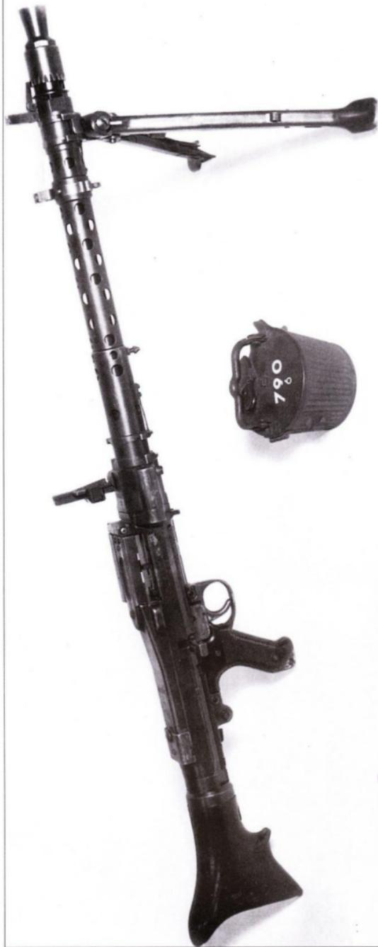
MG 34/41 — модифицированный MG 34, отличающийся большей скорострельностью. Фронтовые испытания пулемета показали неудовлетворительно в части конструкции не более 300 экземпляров.
