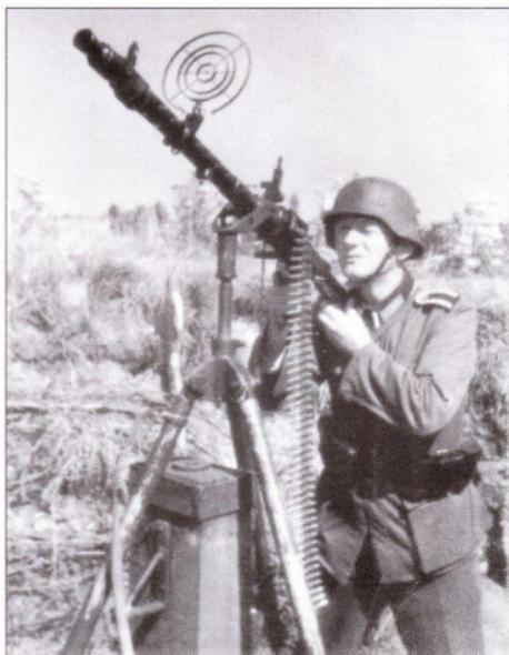
Прекрасный вид на пулемет MG 34 на защитном трехножном станке. Хорошо видны детали кальцевого прицела (Kreiskorn). Деревянный столб, врытый в землю, обеспечивает устойчивость станку.
