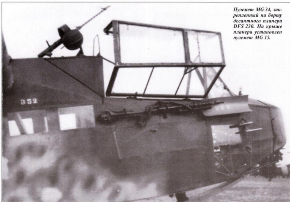
*Пулемет MG 34, закрепленный на борту десантного планера DFS 230. На крыше планера установлен пулемет MG 15.*
