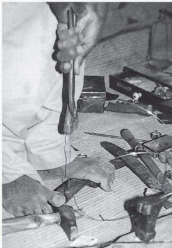
Волочение проволоки и волочила с изогнутой спинкой в традиционной африканской ювелирной мастерской. Фотография сделана в 90-е годы XX века
